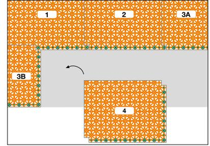
**3** Die Verlegerichtung ist durch die, in der Darstellung grün gekennzeichneten, verjüngten Verbindungsnoppen vorgegeben. Abschnitte  $\geq 30$  cm können am Beginn der nächsten Reihe eingepasst und verklebt werden.
